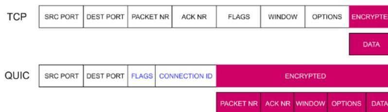
Fig19 : Chiffrement TCP vs QUIC/UDP (en bleu, authentifié, en rose, chiffré)
