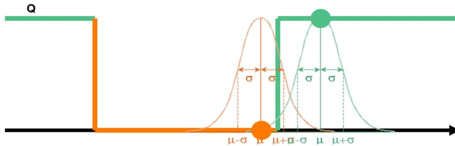
Le schéma Fig51 ci-contre permet de se rendre compte de l'influence d'un jitter suivant une loi normale (jitter est une variance, représentée ici par  $\sigma$ ) sur la position probable du paquet dans le train.
